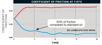
Hours at 115°C / 500g Load / 20Hz / 1000 micron stroke / 1k Ohm)
